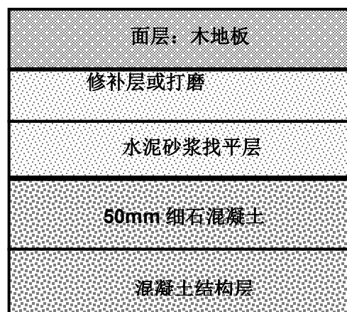
图 3.4 细石混凝土垫层
