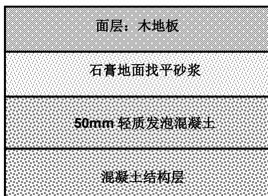
图 3.3 轻质混凝土垫层
